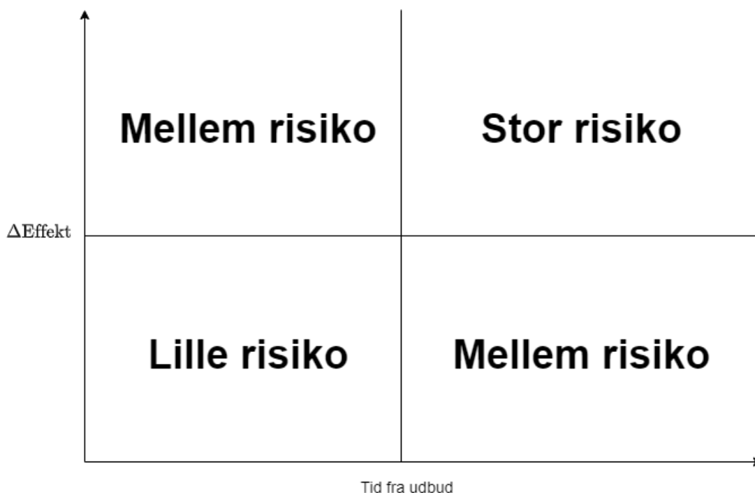
Figur 4 Illustration af usikkerheden ved indikative grænseværdier. \Delta Effekt på y-aksen afspejler ændring i installationsstørrelse.
